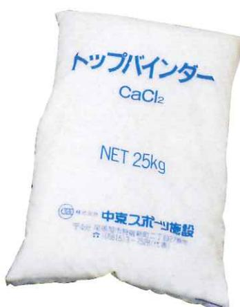
トップバイナーを表面処理に散布すると、空気中の水分を吸収して潮解し、湿潤状態となって防塵効果をあらわします。さらに時間の経過につれてカルシウムと反応し、表土の強度を増します。これはオキシクロライドセメントができるためで、流出しにくく持続性があります。表面の防塵をしている塩化カルシウムの一部は、降雨によって流失しますが、土中に浸透した塩化カルシウムが空気中の水分を吸収し湿潤状態を保持します。
